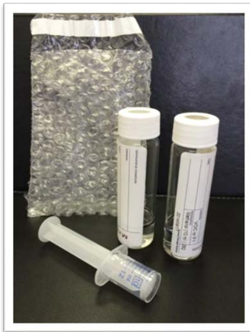
Figure 4 : Matériel d'échantillonnage de type seringue avec conservation des sols dans le méthanol pour l'analyse des COV
