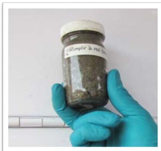
Figure 2 : Contenant de verre rempli de sol pour mesurer le pourcentage d'humidité accompagnant les échantillons prélevés pour la mesure des COV
