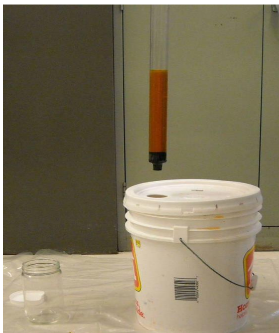
Figure 8 : Tube à clapet de type Bailer
