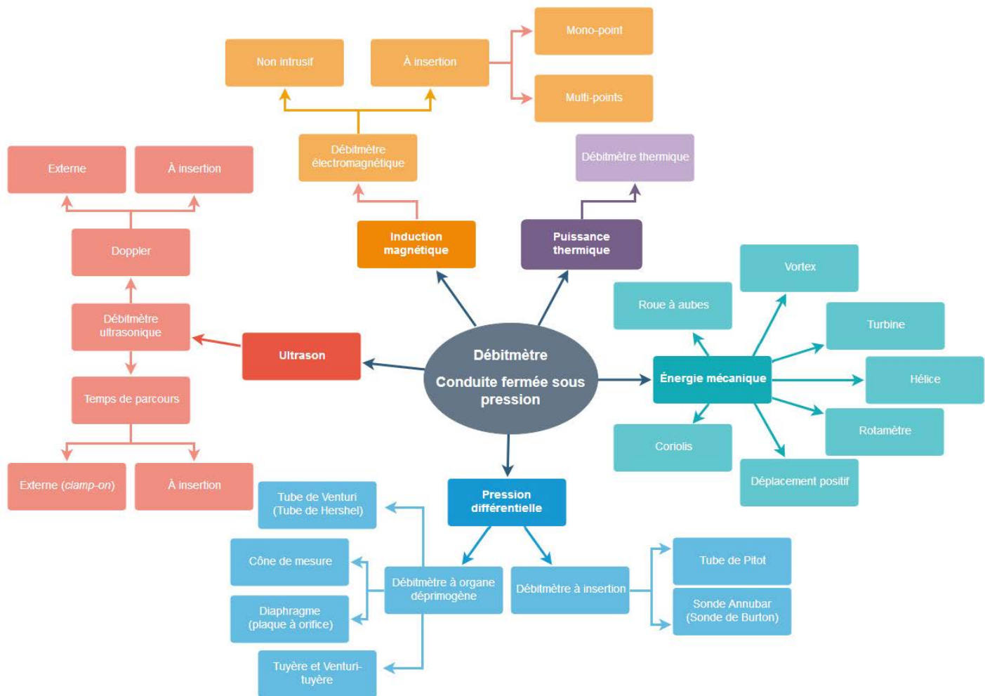
Figure 51 : Classification des débitmètres sur conduite fermée sous pression en fonction de leur principe de mesure
