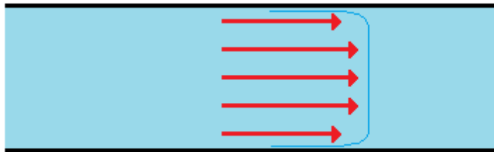
Figure 10 : Profil de vitesse d'un régime turbulent
