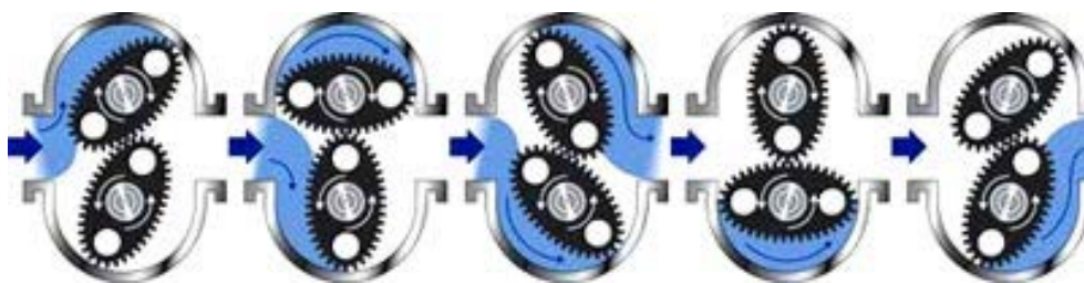
Figure 71 : Fonctionnement du débitmètre à déplacement positif
