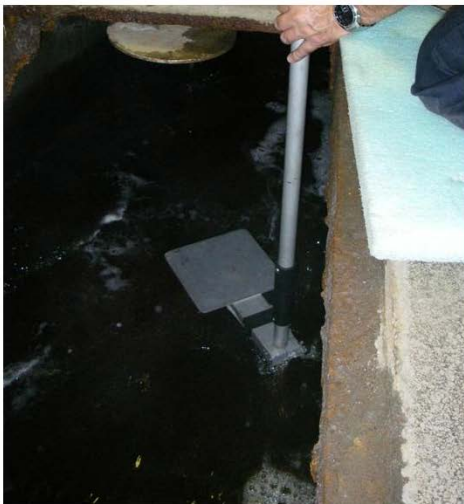
Ajustement et utilisation d'une plaque de référence temporaire
